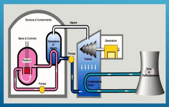
Le centrali nucleari sono diverse dalle centrali termoelettriche convenzionali nel modo con cui si produce il calore, per il resto sono uguali. Rispetto ad una centrale a gas, anziché bruciare gas si brucia «massa»
